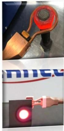
Es ist der kleinste Heizer seiner Art, geeignet für Werkstätten, Schreinereien, Karosserie- und Reifenwerkstätten, zum Richten, Biegen, Auswechseln von Lagern, Lösen von verrosteten Schrauben und Entfernen von Lacken. Dank seiner kompakten Abmessungen kann er leicht transportiert werden, um jede Art von Arbeit durchzuführen, wo immer sie benötigt wird.
